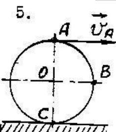
Колесо радиуса  $R$  катится без скольжения равномерно, причем скорость верхнего конца диаметра  $U_A = 2 \text{ м/с}$ . Зная положение мгновенного центра скоростей (точка С). Определить направление скорости точки В, а также величину и направление скорости точки О.
