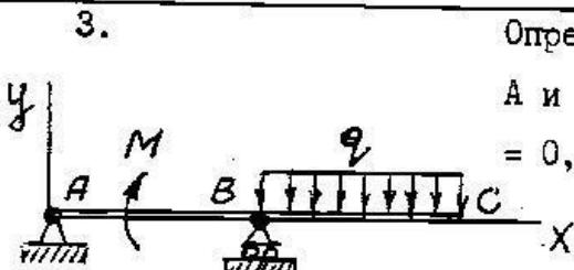
Определить реакции неподвижного шарнира А и подвижного шарнира В, если:  $AB = BC = 0,6 \text{ м}$ ;  $q = 500 \text{ нм}$   $M = 30 \text{ нм}$ .
