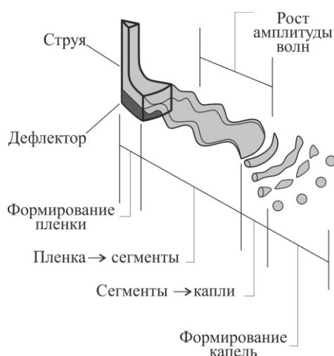
Рис. 1. Схема распада струи в спринклерном оросителе.
