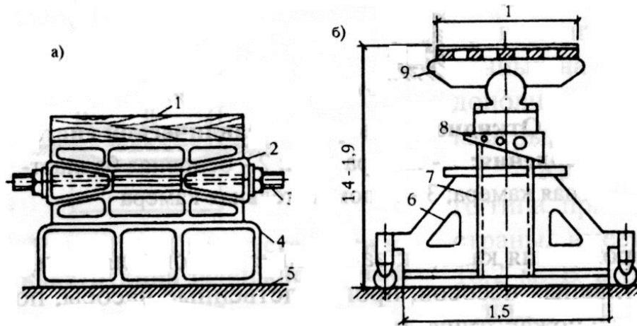
Рис.4. Конструкция доковых опор.
