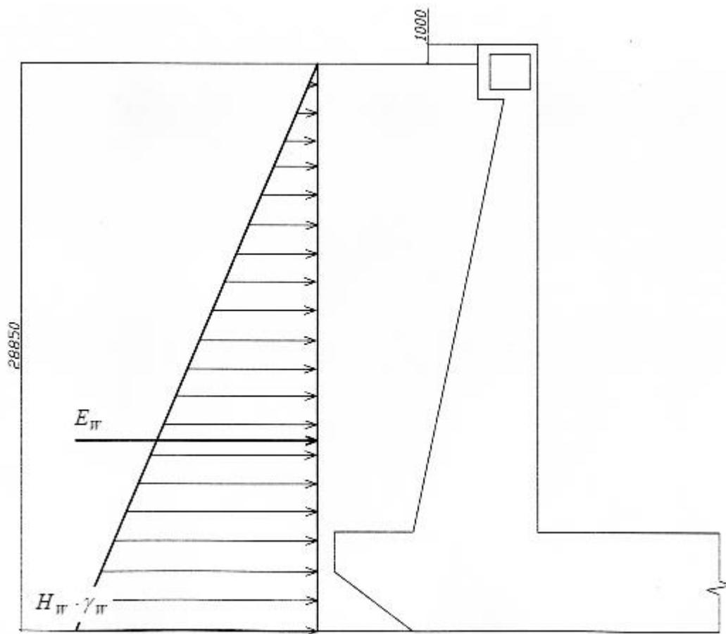
Рис. 13. Схема гидростатического давления воды на док.
