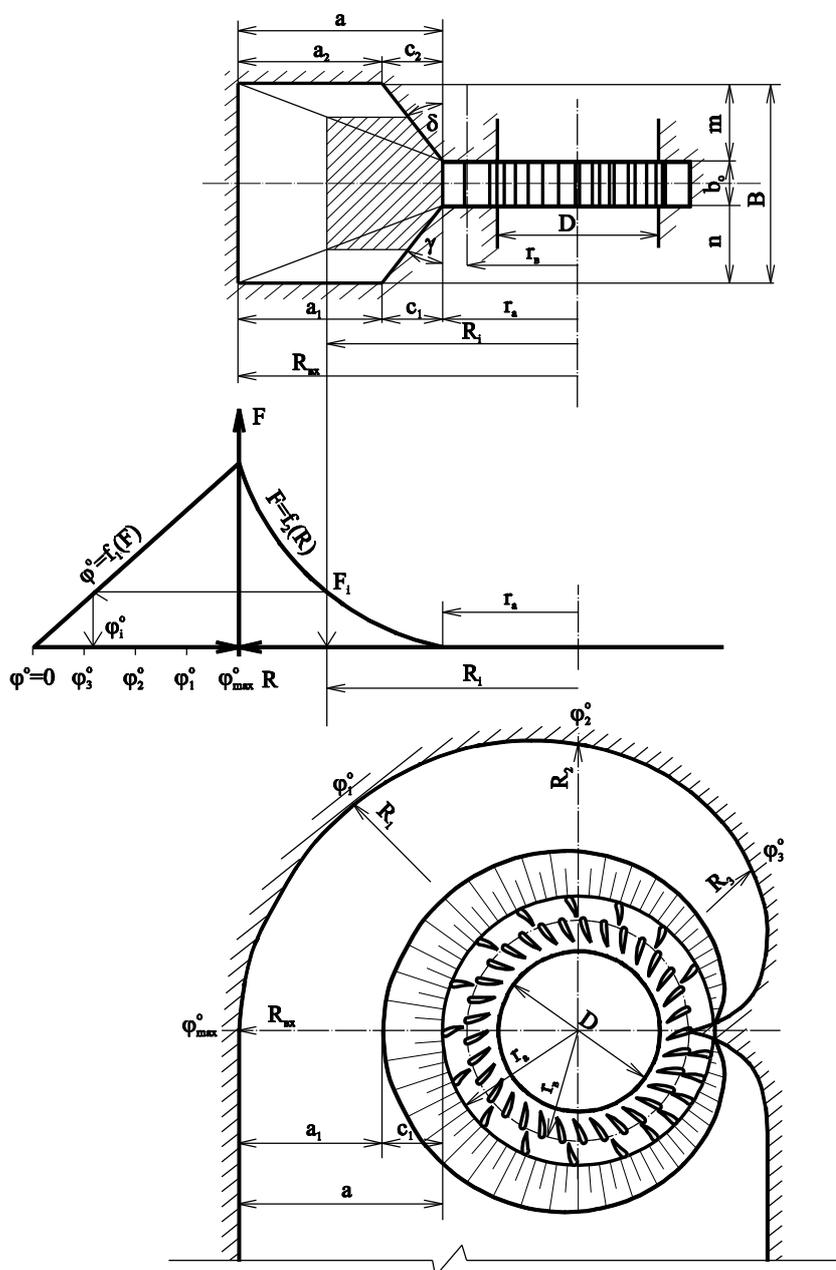
Рис. 6.1. К графо-аналитическому расчету спиральных камер таврового сечения [8].
