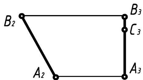
**Задача 3.** Дано: комплексный двухпроекционный чертёж отрезка АВ прямой; проекции точек С, D, E. Определить взаимное положение точки и прямой, построить недостающие проекции прямой, написать название прямой.
