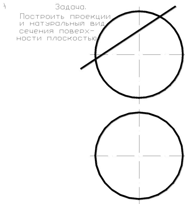
**ЗАДАЧА 3:** Построить проекции и натуральный вид сечения поверхности плоскостью.
