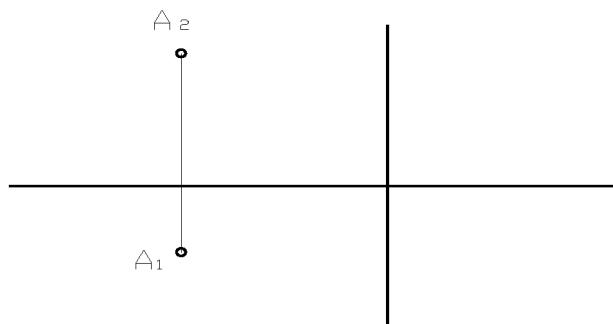
**Задача 5.** Определить натуральную величину отрезка АВ и угол наклона к фронтальной плоскости проекций. Написать алгоритм решения задачи.
