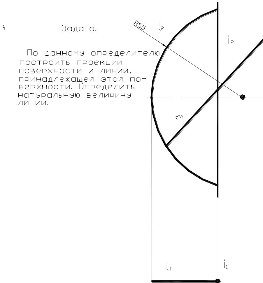
**ЗАДАЧА 2:** Построить проекции и натуральный вид сечения поверхности плоскостью.
