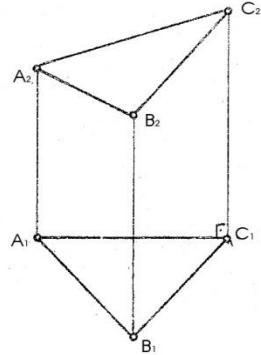
56) Дано: пл. Г(a II b) А с Г. Опред.  $\angle$  наклона пл. Г к  $\Pi_2$  пользуясь линией наибольшего наклона
