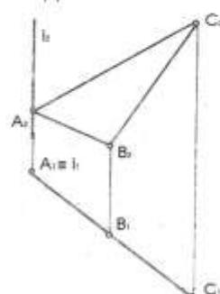
54) Дано:  $a(a_1, a_2)$  и  $b(b_1, b_2)$ . Опред. угол между  $a$  и  $b$ .
