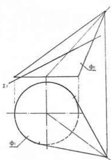
62) Дано: поверхн. цилиндра вращения  $\phi$  и пл.  $\Gamma(a \parallel b)$ . Построить линию взаимного пересечения.
