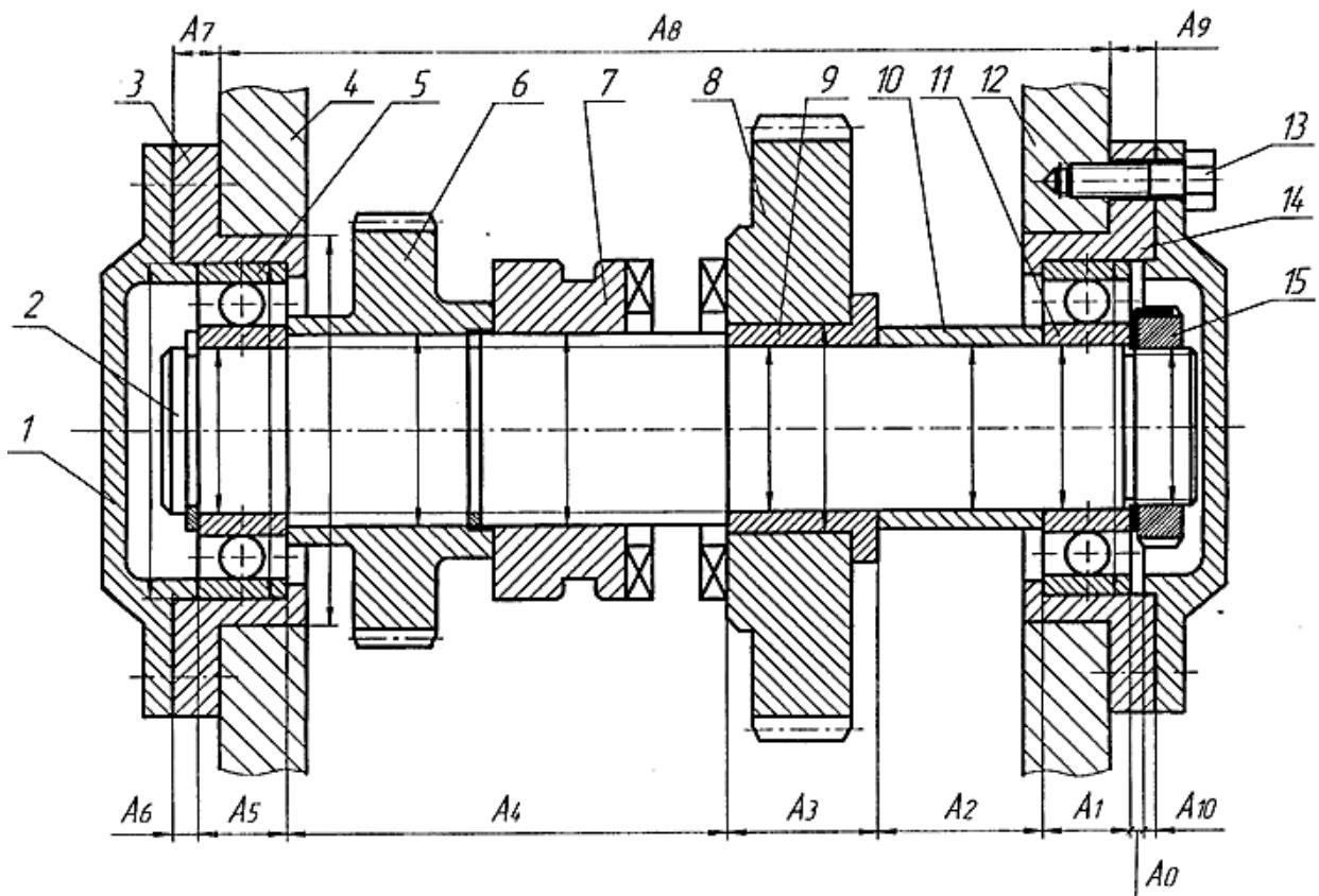
Рисунок 3. Схема промежуточного вала коробки передач
