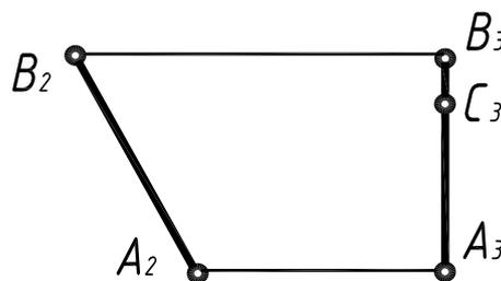
**Задача 3.** Дано: комплексный двухпроекциионный чертёж отрезка АВ прямой; проекции точек С, D, E. Определить взаимное положение точки и прямой, построить недостающие проекции прямой, написать название прямой.
