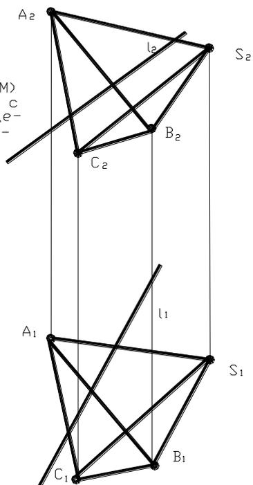
**ЗАДАЧА 6:** Определить натуральную величину двугранного угла при ребре АВ. Определить видимость сторон угла на плоскостях проекций. Определить принадлежит ли точка М грани АВС.
