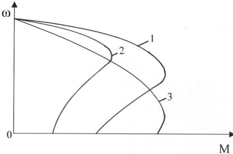
12. На каком рисунке представлены механические характеристики асинхронного двигателя с короткозамкнутым ротором при регулировании скорости вращения изменением числа пар полюсов при постоянной мощности нагрузки?
