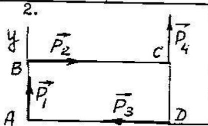
Определить главный момент системы сил  $\vec{P}_1$  ( $P_1 = 20$  н),  $\vec{P}_2$  ( $P_2 = 40$  н),  $\vec{P}_3$  ( $P_3 = 60$  н) и  $\vec{P}_4$  ( $P_4 = 20$  н) относительно вершины A прямоугольника ABCD, где  $BC = 2 AB$ .
