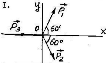
Определить равнодействующую плоской системы сходящихся сил  $\vec{P}_1$ ,  $\vec{P}_2$  и  $\vec{P}_3$  ( $P_1 = P_2 = P_3 = 100$  н).
