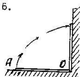
Определить работу, необходимую для того чтобы однородную доску длиной  $OA = 2$  м и весом  $G = 20$  кг прислонить вертикально к стене, повернув из горизонтального положения вокруг точки O. Принять  $g = 10$  м/с<sup>2</sup>.
