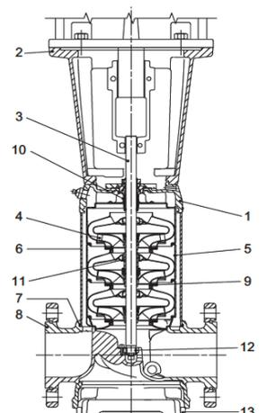
5. Какой тип насоса представлен на рисунке? При каких требуемых параметрах жидкости используют насосы данного типа?
