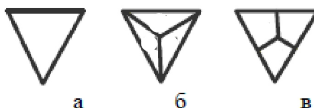
Рис.34. Расположение граней тетраэдра (а) и ее производных форм: тригон-три-тетраэдра (б) и тетрагон-три-тетраэдра
