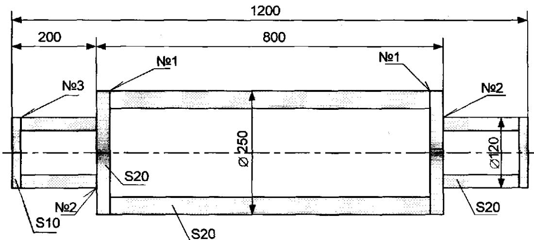
**7. РАЗРАБОТАТЬ ТЕХНОЛОГИЮ СВАРКИ КОЖУХА ПОЛУОСИ АВТОМОБИЛЯ «УРАЛ» (ПРОГРАММА ВЫПУСКА - 20 ТЫСЯЧ ШТУК).**
