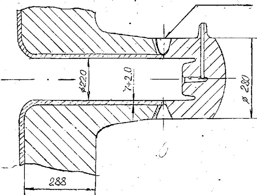
**9. РАЗРАБОТАТЬ ТЕХНОЛОГИЮ СВАРКИ И НАПЛАВКИ ОБЕЧАЙКИ.
