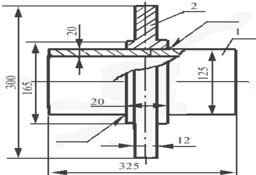
**8. РАЗРАБОТАТЬ ТЕХНОЛОГИЮ ПРИВАРКИ КОРПУСА ДАТЧИКА ДАВЛЕНИЯ К КОРПУСУ РЕАКТОРА. (ПРОГРАММА 10 ШТУК В ГОД).**
