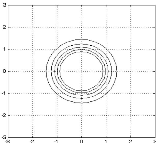
2.2. Расчет температурного поля мгновенного линейного источника в пластине без теплоотдачи.
