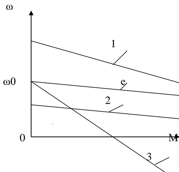
5. Какая из представленных на рисунке механических характеристик двигателя постоянного тока независимого возбуждения соответствует наибольшей величине введенного в цепь якоря добавочного последовательного сопротивления?
