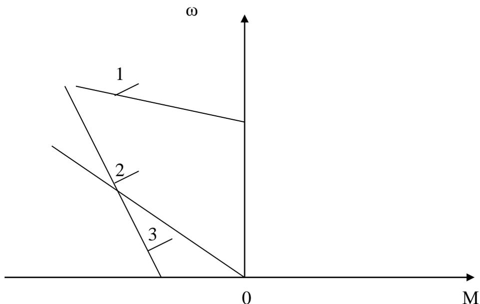
7. Укажите формулу механической характеристики двигателя постоянного тока независимого возбуждения в режиме динамического торможения
