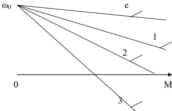
6. Какой схеме включения двигателя постоянного тока последовательного возбуждения соответствует данная искусственная механическая характеристика?
