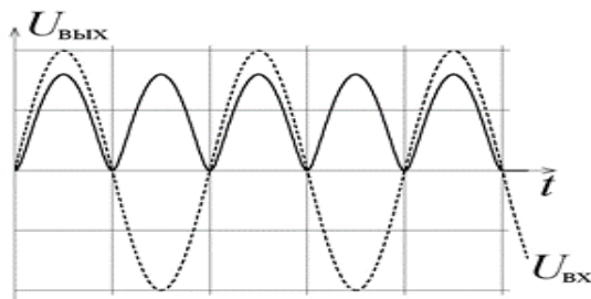
Рис. 4. Диаграммы работы двухполупериодного выпрямителя
