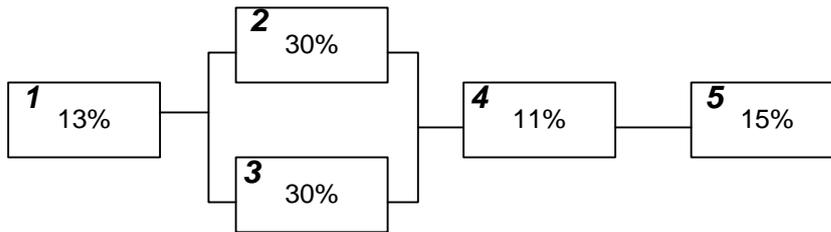
Вероятность выхода из строя каждого прибора указана на рисунке. С помощью имитационной модели найти вероятность выхода из строя всей системы.
