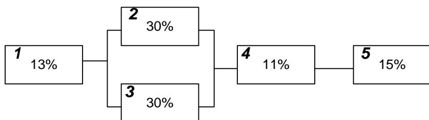
Вероятность выхода из строя каждого прибора указана на рисунке. С помощью имитационной модели найти вероятность выхода из строя всей системы. Очевидно, что вероятность выхода из строя всей системы произойдет в случае, если выйдут из строя приборы 1 или 4 или 5 или одновременно 2 и 3.
