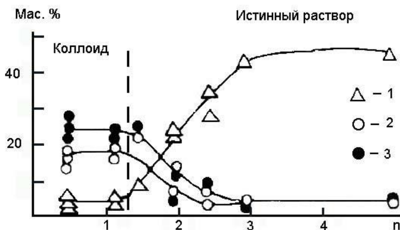
Рис.1.7 [103]. Зависимость элементного состава покрытий от мольного соотношения компонентов n = \frac{[P_6O_{18}]^{6-}}{[Me^{2+}]} в области перехода от истинного раствора к коллоиду. Анодные слои получены на сплаве АМцМ в электролите \text{Na}_6\text{P}_6\text{O}_{18} и \text{Mn}(\text{CH}_3\text{COO})_2 \cdot 4\text{H}_2\text{O} . 1-Аl; 2-Р, 3-Мn.
