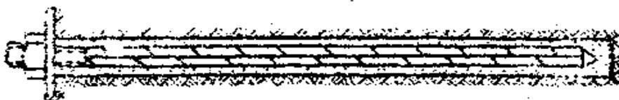
Рис. 13. Анкер с железобетонным замком
