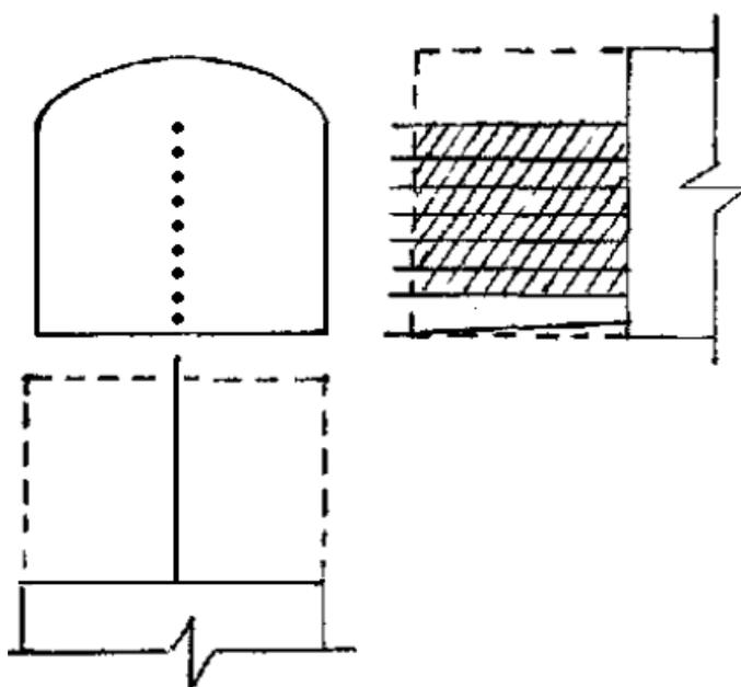
Рис.17. Схема щелевого вруба
