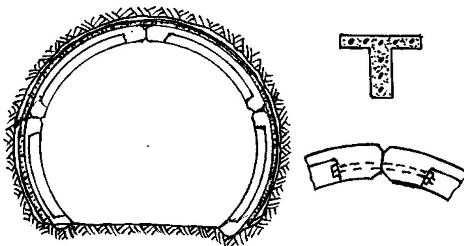
Рис.10. Подковообразная форма выработки
