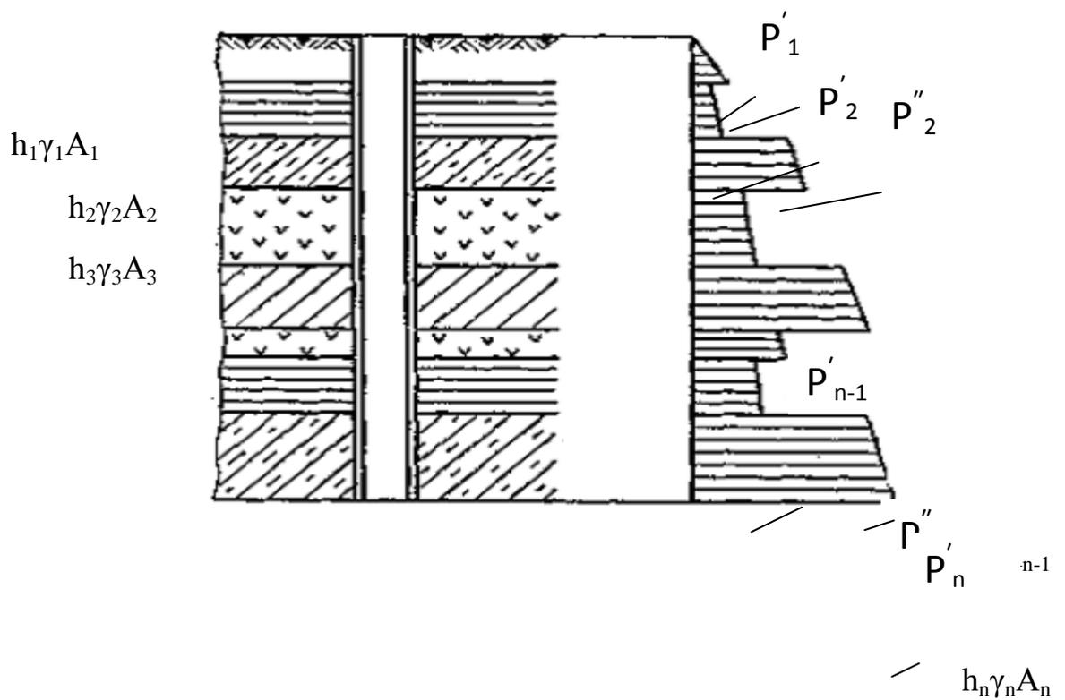
Рис. 7. Схема к определению горного давления
