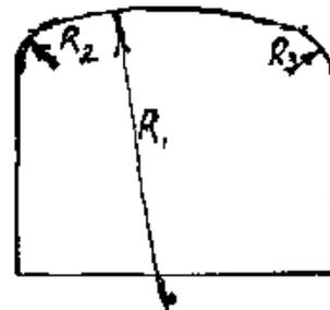
Рис. 4. Коробовая форма выработки
