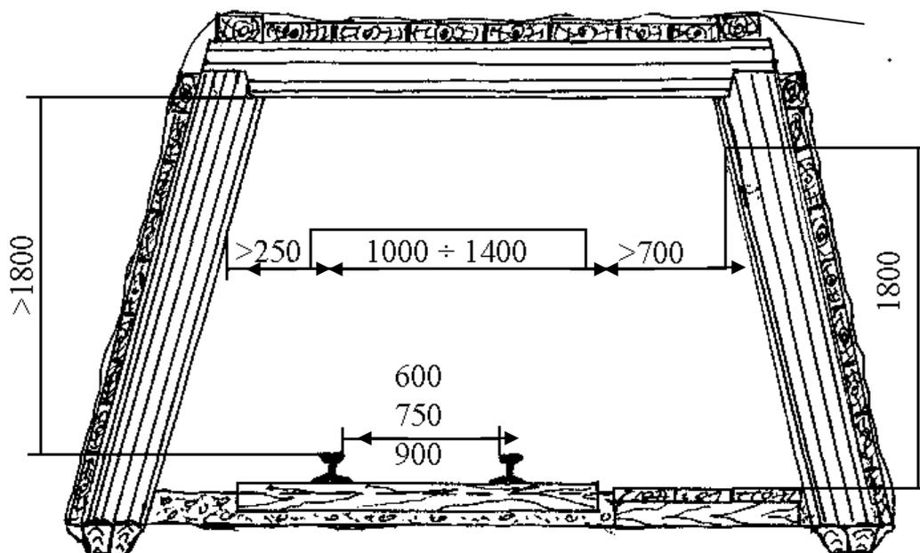
Рис. 6. Размеры поперечного сечения выработки
