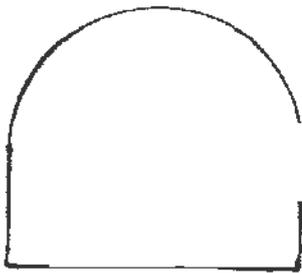
Рис. 3. Полуциркульная форма выработки
