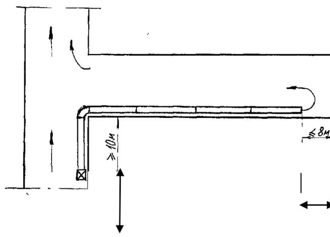
Рис.24. Схема нагнетательного проветривания
