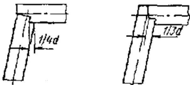
Рис. 9. Схема соединения верхняка со стойкой в лапу
