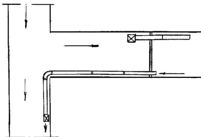
Рис.26. Схема комбинированного проветривания
