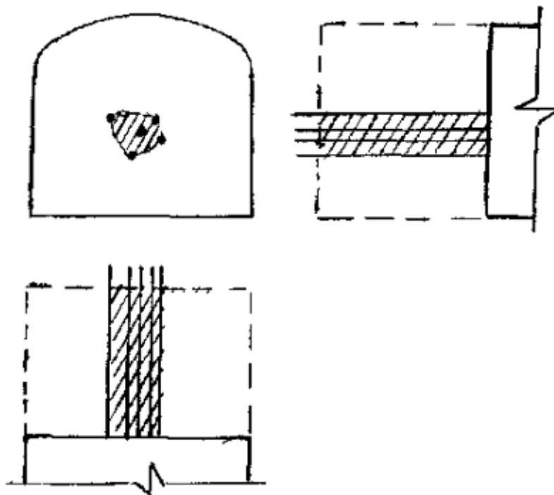
Рис.19. Схема спирального вруба
