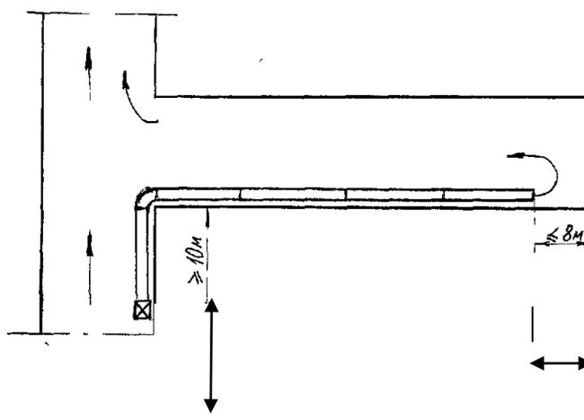
Рис.24. Схема нагнетательного проветривания
