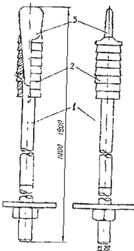
Рис. 12. Анкер с распорным замком конструкции КузНИУИ
