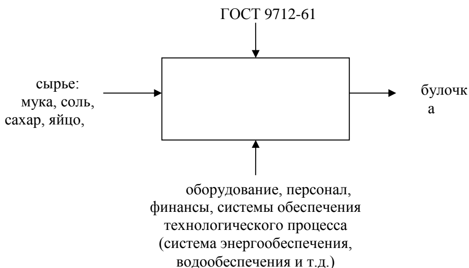
Рисунок 6. Элементарная схема производства булочки
