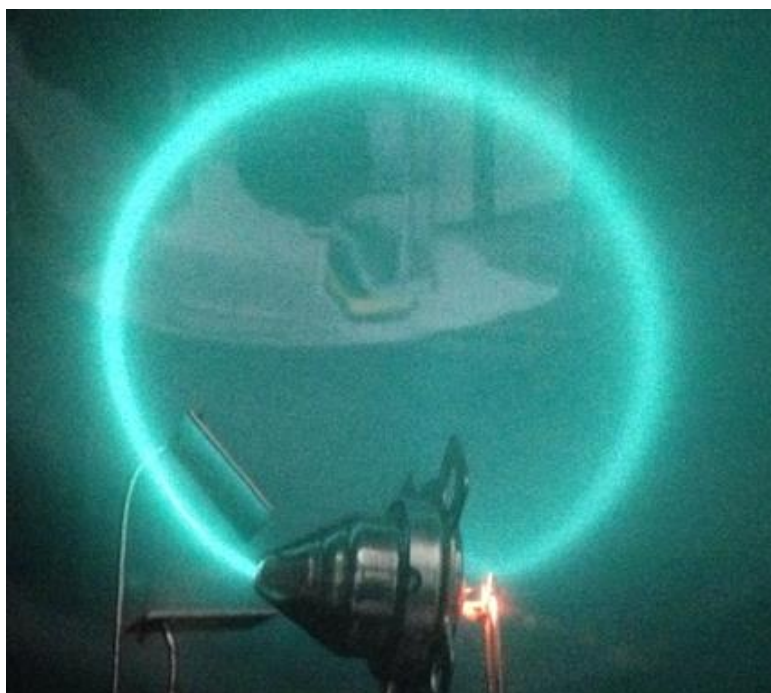
Рис. 5. Вид электронного луча в магнитном поле, создаваемом магнитным полем катушек Гельмгольца.
