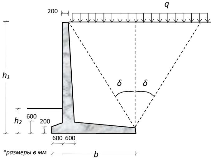
Проверить устойчивость сооружения на плоский сдвиг и опрокидывание
