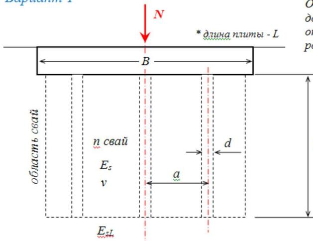
Определить осадку фундамента и долю нагрузки, воспринимаемую отдельно сваями и отдельно ростверком
