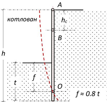
Выполнить проверку устойчивости тонкой стенки при заданной глубине заделки шпунта  $t$
